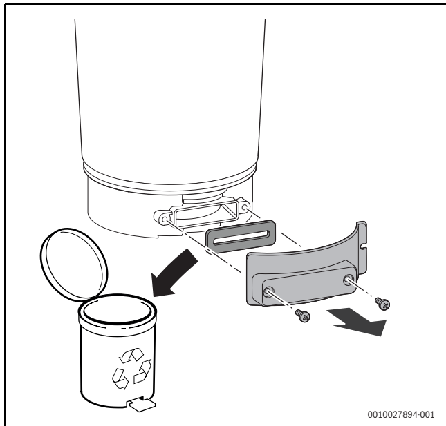
Мал. 58 Відкриття контрольно-ревізійного отвору
